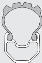
I pneumatici senza camera d'aria devono essere montati senza utensili e rimossi dal cerchio, altrimenti possono verificarsi delle impermeabilità. Se il liquido di tenuta non basta per impedire un difetto, dopo aver rimosso la valvola, può essere inserita una normale camera d'aria.
