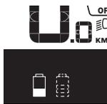
Se in una eBike con due batterie inserite verranno caricate entrambe le batterie, sul display verrà visualizzato l'avanzamento della carica per entrambe le batterie (nella figura, la batteria in fase di carica è quella sinistra). L'indicazione lampeggiante sulla batteria indicherà quale delle due batterie si trovi al momento in fase di carica.
